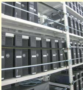
金属材料研究所に設置された大規模超並列コンピュータクラスター
